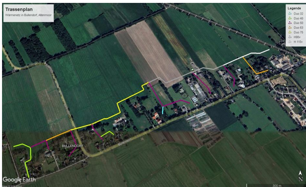
Abbildung 71: Trassenskizze für ein Wärmenetz in Bullendorf
